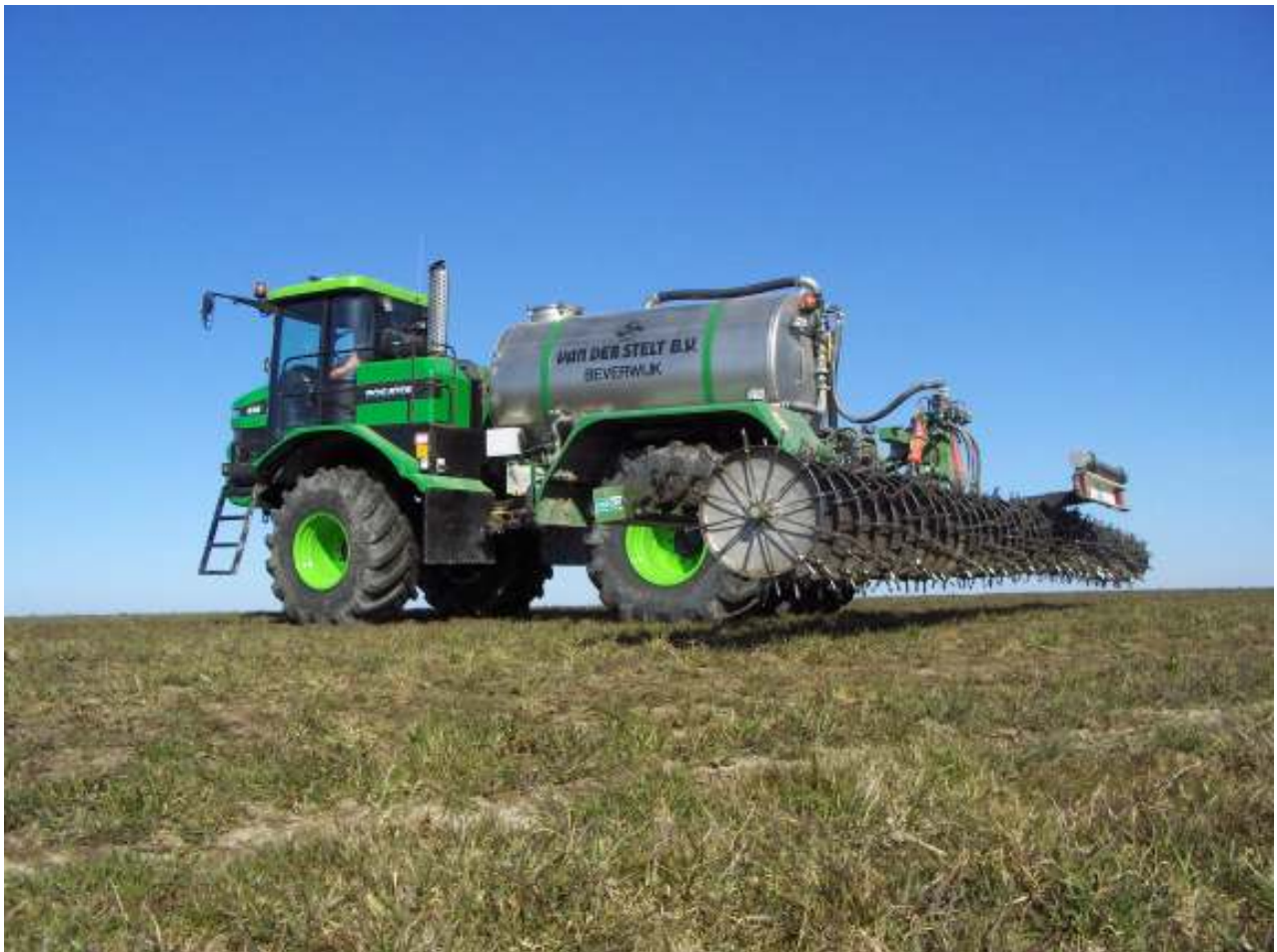
Gerät der Fa. Duport auf Rogator von Ag-Chem als Selbstfahreinheit
