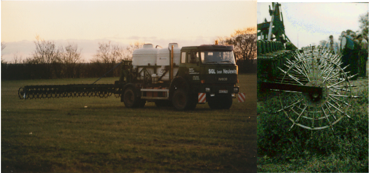
Injektion auf Grünland bei SGL mit Technik der ersten Generation, mit viel Bodendruck
